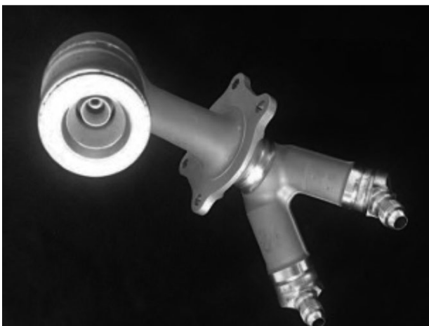
图9 LEAP 发动机燃油喷嘴 [6]
