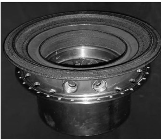
图15 异种材料混合制造的航空发动机轴承后机匣
