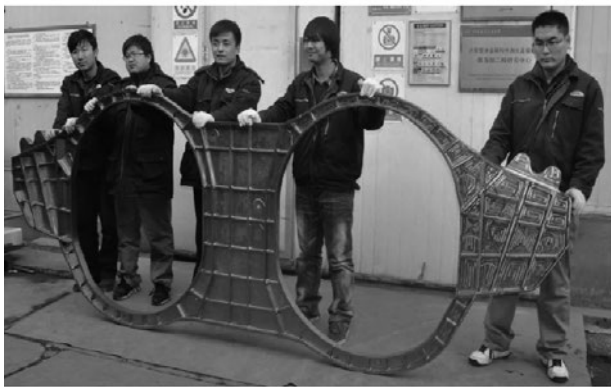
图8 激光增材制造的飞机大型钛合金加强框
