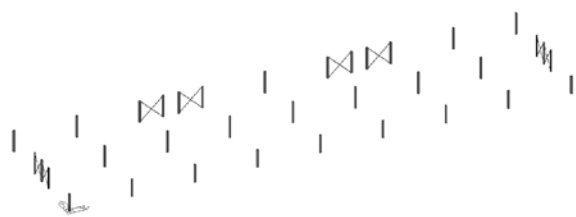
图7 方案三36m×34m柱网+左右山墙及后山墙柱间支撑
