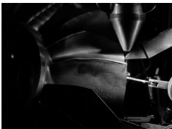
图12 激光增材制造修复叶片 [1]
