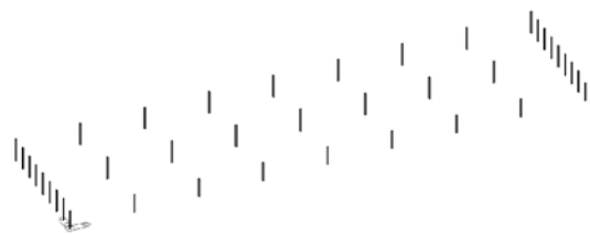
图6 方案二36m×34m柱网+左右山墙密柱
