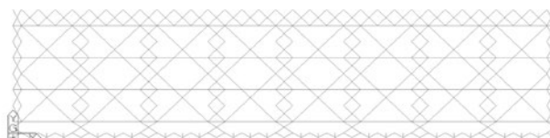
图12 下弦支撑布置图
